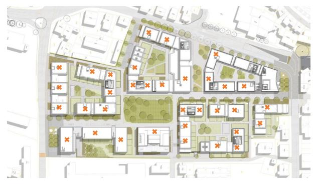
Abbildung 3: Abbildung der Dächer die zu einem Anteil mit Photovoltaikanlagen belegt werden.
